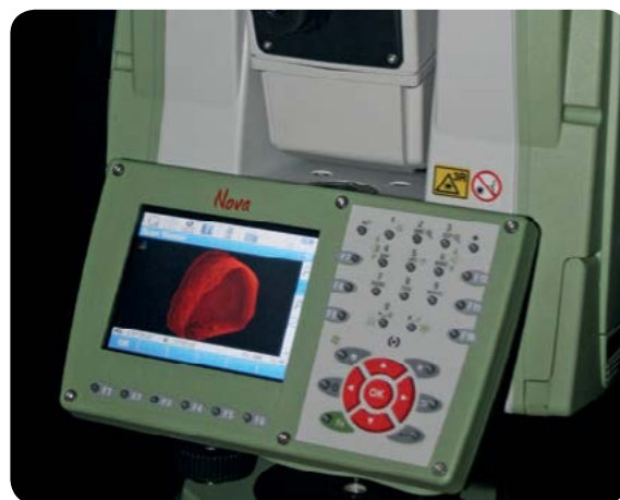
■ Облако точек на дисплее сканирующего тахеометра
